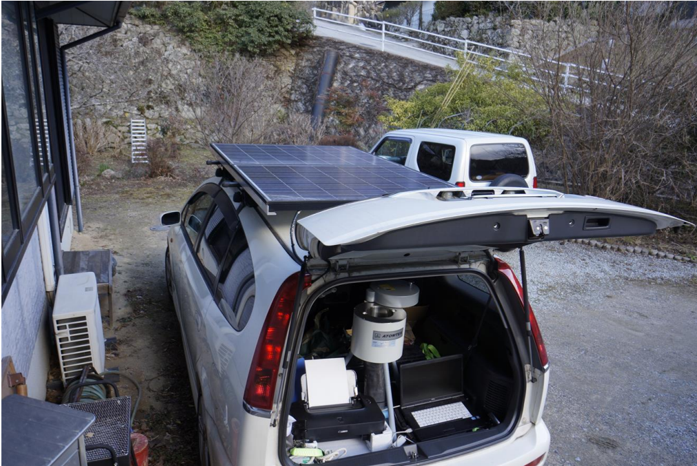
屋根にソーラーパネル300W バッテリー2kwh搭載
